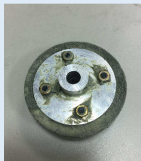
圖2 羊毛輪拋光刀具照相圖
