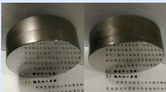
圖5 原先磨漿(左)與膏狀磨漿(右)羊毛輪拋光結果比較圖
