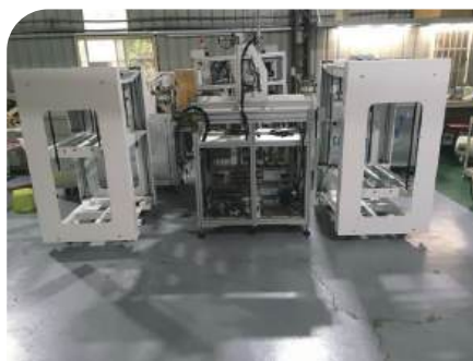
弾性材料の移動／貼り合わせ／ 位置決めを全自動で統合する設備
