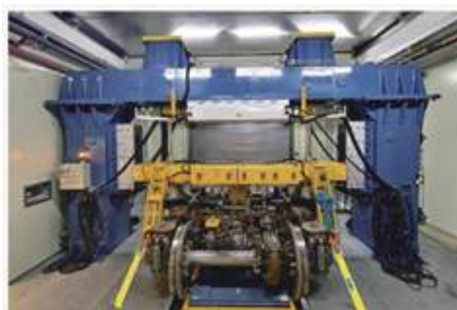
ターンテーブル走行試験設備
