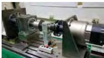
RV減速機性能測試機台
