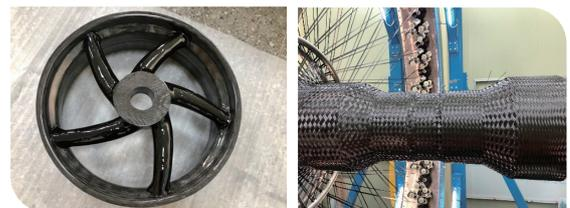
不規則構造及び細長い複合材編み製品
